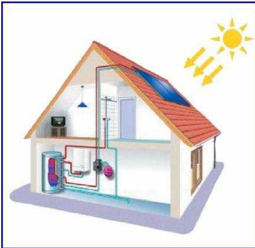
Egy komplett (melegvíz készítés napenergiás táplálással) fűtési rendszer családi ház esetében
